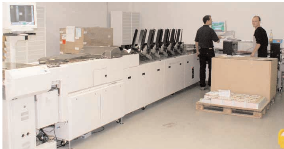
Mit der Anlage von Pitney Bowes FX10F Series werden die gedruckten Produkten über die 2-D-Codes gelesen und bis zu 24 Beilagen zugeführt. Täglich werden bis zu 50 000 Postsendungen in der Nacht verarbeitet.
