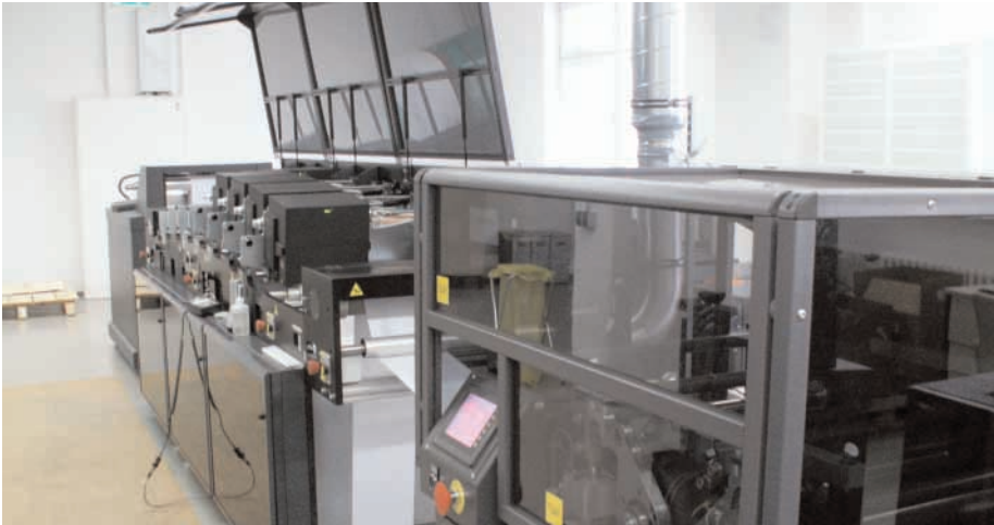
Die Digitaldruckmaschine Kodak Versamark VT 3000 ist mit acht Inkjetdruckköpfen ausgestattet. Mit einer Leistung von bis zu 2 000 DIN-A4-Seiten/min lassen sich 4/4-farbige Produkte in einem Durchgang herstellen – Individualisierung inklusive.
